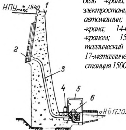
Поперечный разрез плотины и здания ГЭС
