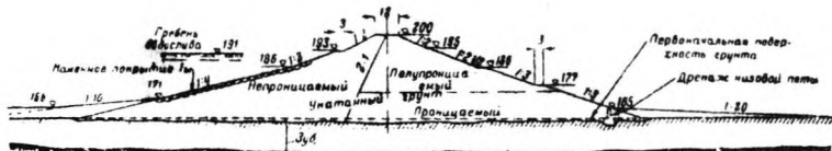
Поперечный разрез плотины
